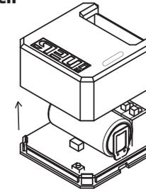
Remove the top cover of the product. Entfernen Sie die obere Abdeckung des Produkts.
