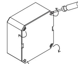
Using a screwdriver and a light lever in the groove outwards, unlock the four sides of the snap. Verwenden Sie einen Schraubendreher und hebeln Sie die Laschen an den vier Seiten der Nut leicht heraus.
